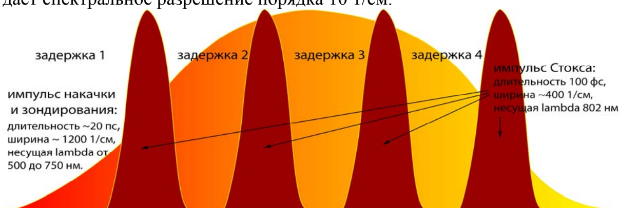
Рис.1 Двухимпульсная схема генерации КАРС сигнала.
